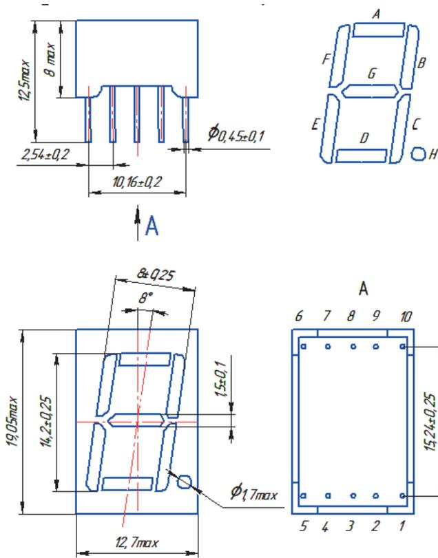
Рисунок 1 – Габаритный чертеж на индикаторы КИПЦ57А-1/7, КИПЦ57А1-7
