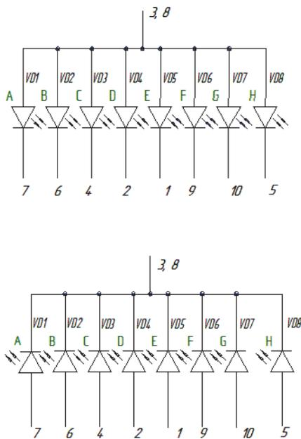
Рисунок 2 – Схема электрическая принципиальная для индикаторов КИПЦ57А-1/7, КИПЦ57А1-1/7
