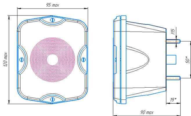
Назначение прибора светового ФЗХ-27-Б (далее прибор) – фонарь заднего хода на машинах (спецтехнике).
