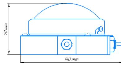
Прибор световой в корпусе изделия ПС04-25/5-70/70-Б/С-28-10/16 с регулятором яркости и тумблером предназначен для местного и светомаскировочного освещения объекта.
