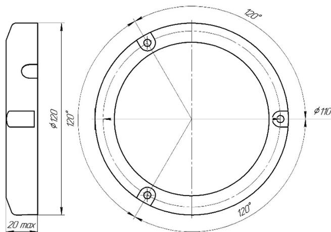
Прибор световой ПС14-30-70/70-Б-28-05 (далее прибор) предназначен для местного освещения объекта.
