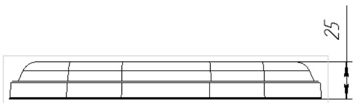
Прибор световой ПС17-100-70/70-Б-28-15 (далее прибор) предназначен для общего освещения объекта.
