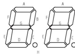
Схема электрическая с общим анодом
