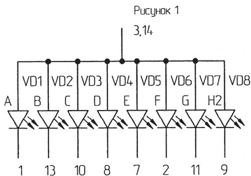
Схема электрическая с общим катодом
